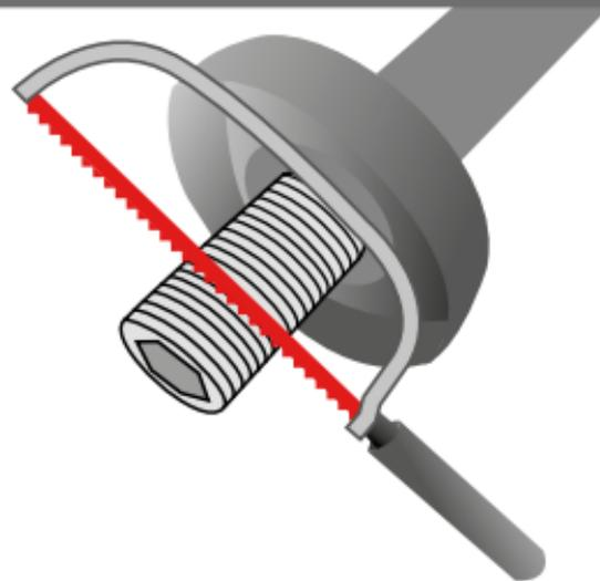
Um den Wand-/Deckenarm unter Zug in die richtige Stellung zu bringen, längen Sie diesen ab!
