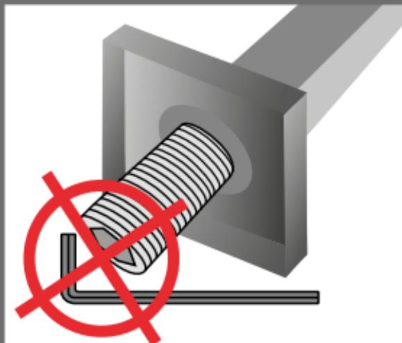
Achtung, den Gewindenippel niemals herausdrehen! Der Wandarm verliert dadurch an Stabilität und darf nicht mehr montiert werden – KEINE GARANTIE!
