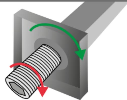
Achten Sie bei eckigen Wand-/Deckenarmen darauf, dass Sie die Rosette beim einschrauben mitdrehen. Ansonsten riskieren Sie beim anziehen Kratzer auf der Rosette!
