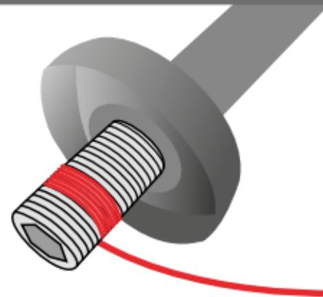
Verwenden Sie zur Abdichtung ausschließlich ein zugelassenes Dichtband.
