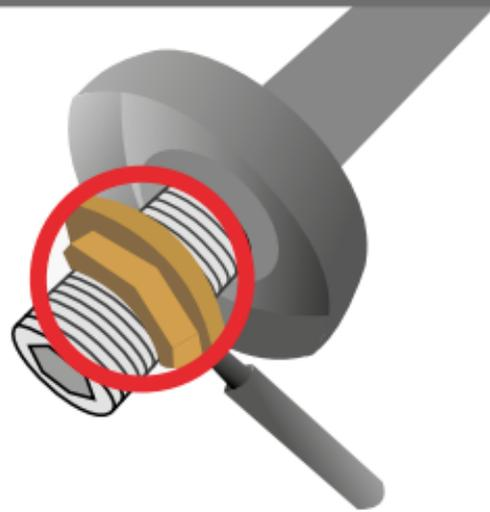
Bitte verwenden Sie die Überwurfmutter ausschließlich bei Trockenbauwänden zum gegendrehen! Ansonsten ist die Überwurfmutter zu entsorgen!
